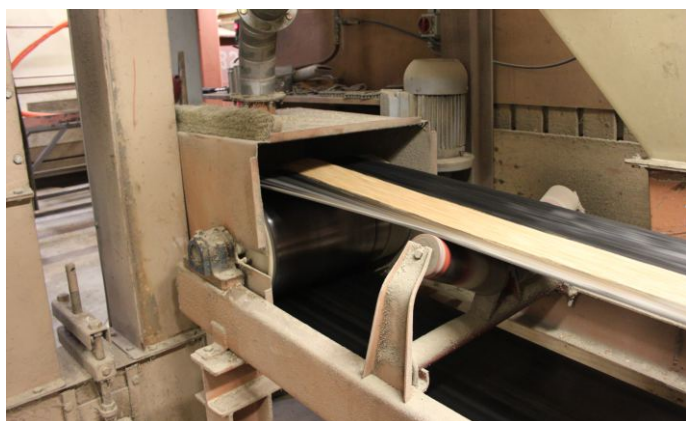
Usuwanie zanieczyszczeń żelaznych z kruszywa.
