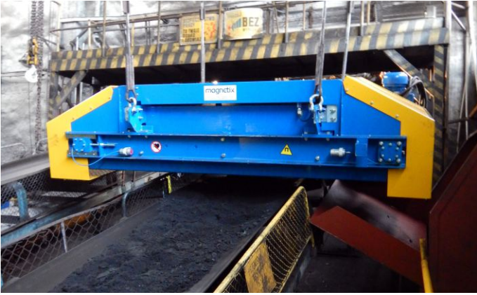
Usuwanie zanieczyszczeń żelaznych z węgla kamiennego.
