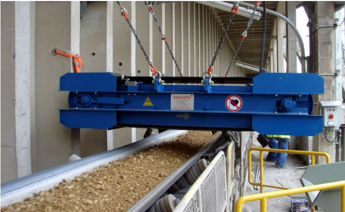
Usuwanie zanieczyszczeń żelaznych z klinkieru.
