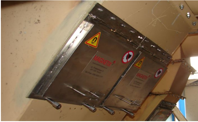
Usuwanie zanieczyszczeń żelaznych ze zrębków drzewnych.
