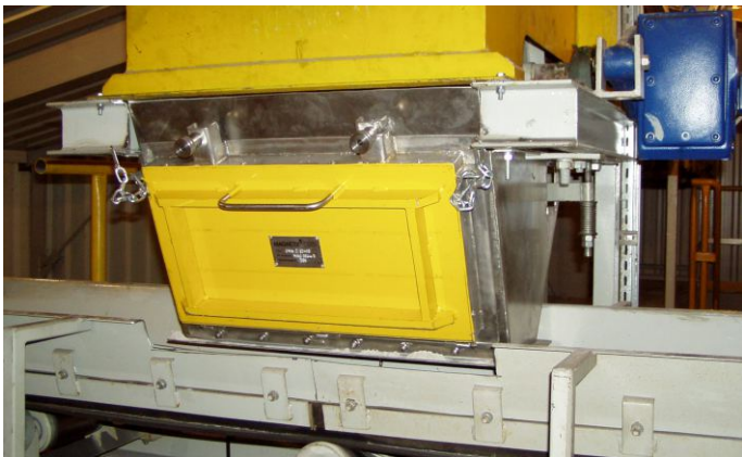
Usuwanie zanieczyszczeń żelaznych z mączki kwarcowej.
