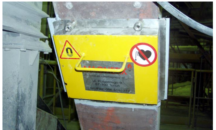
Usuwanie zanieczyszczeń żelaznych z mączki wapiennej.
