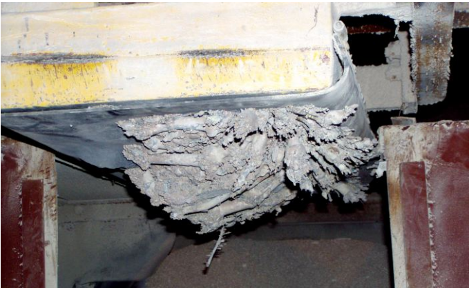
Zanieczyszczenia żelazne wychwycone z nawozów fosforowych.
