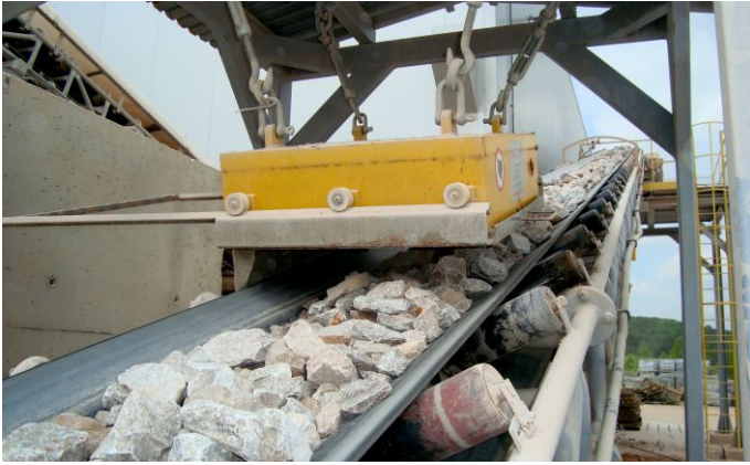
Usuwanie zanieczyszczeń żelaznych z kamienia dolomitowego.
