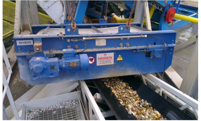
Usuwanie zanieczyszczeń żelaznych z kruszywa.
