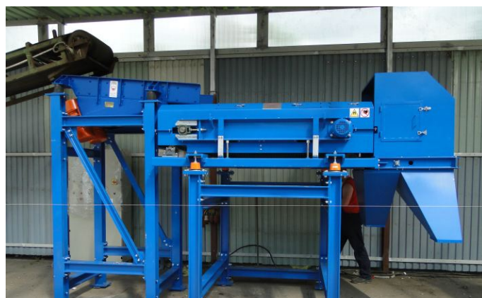
Oczyszczanie stłuczki szklanej z metali nieżelaznych.
