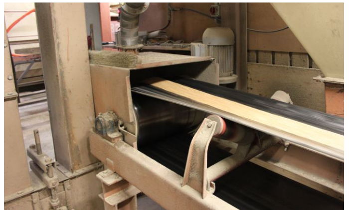
Usuwanie zanieczyszczeń żelaznych z ziarna.
