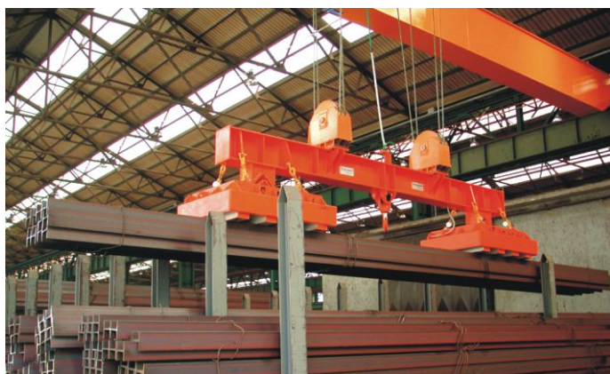
Transport kształtowników stalowych.
