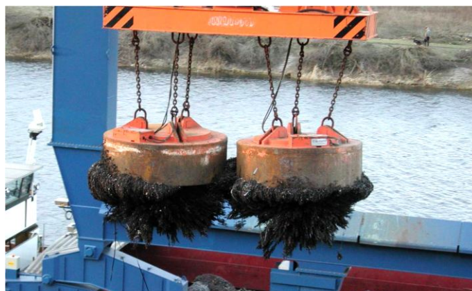
Przeładunek wiórów stalowych.
